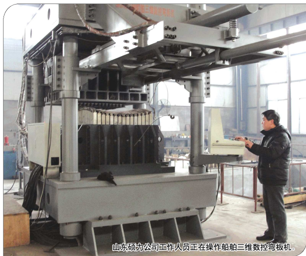
山东硕力公司工作人员正在操作船舶三维数控弯板机。
