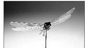
蜻蜓窃听器 这种微型空中无人机(UAV)是第一款昆虫外观的无人机,它利用随身携带的迷你设备进行情报收集。
