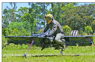
▲飞行摩托正在进行地面测试。
