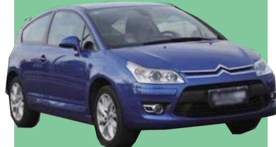
雪铁龙新款C4已经推出,而C4-Coupe并没有换代,依旧采用一款1.6升双涡流涡轮增压汽油发动机(双涡流就是发动机排出的废气,通过两根气管分别推动涡轮,气流更均匀,在低速时就可以使涡轮进行工
