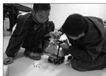
测电话铃声和水开声;“屁股”上则有三个分别标着“123”的用于发出信号的小灯泡,当机器人监测到有人来时,会闪烁1号灯;当听到水壶烧开时的警笛声,会闪烁2号灯;听到电话、传真铃声会闪烁3号灯。
