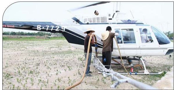
▲18日,碧海路附近空地上,“飞防”直升机正在加灌药剂。直升机两侧的长长白管用于“飞防”时喷药。
