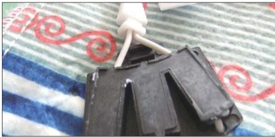
合格的电热毯端口处有固定物,而廉价电热毯没有。
