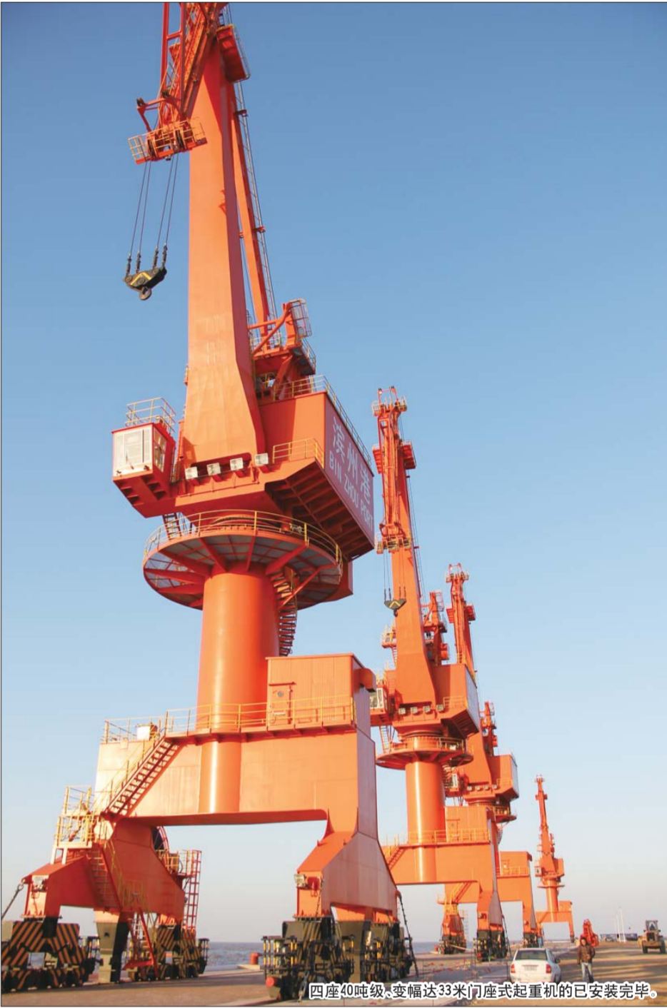
四座40吨级、变幅达33米门座式起重机的已安装完毕。
