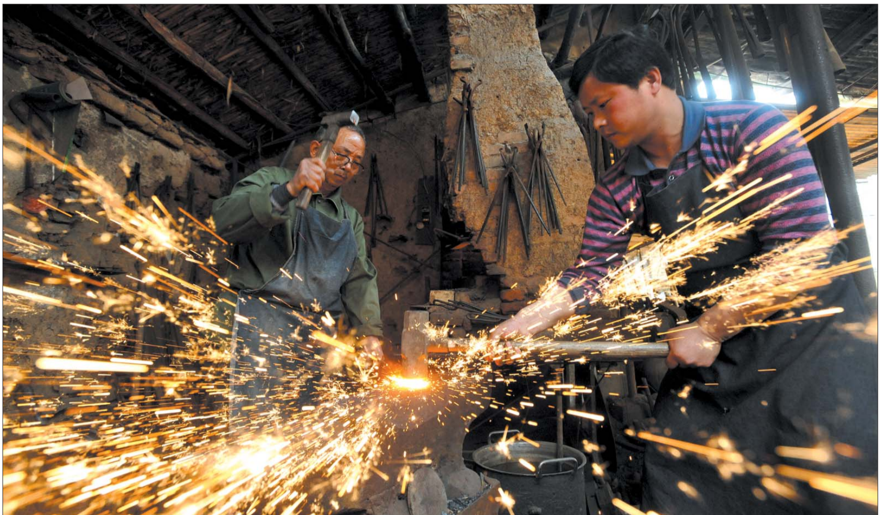
4日上午10时许,父子两人正在打铁,牛老汉掌小锤,儿子砸大锤,大锤落下,火花四溅。
