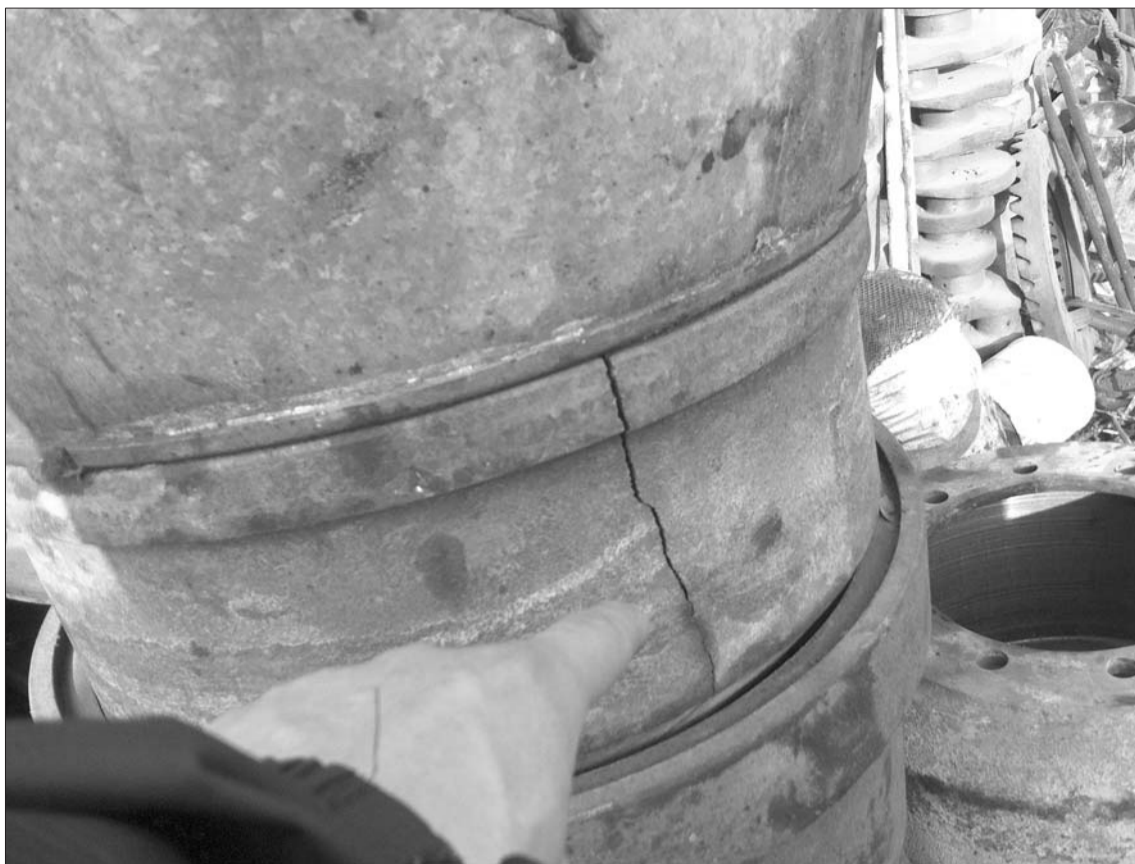
在济南二环北路上的一家汽修厂内,废弃的刹车鼓堆在一起,有些已有明显裂痕。本报记者 吴金彪 摄 一家汽配店内的刹车鼓,店主承认是副厂件。本报记者 吴金彪 摄
