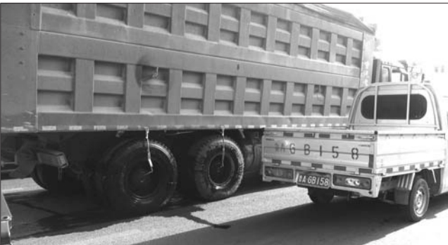
工业北路上一辆货车正在为车轮滴水降温。本报记者 吴金彪 摄
