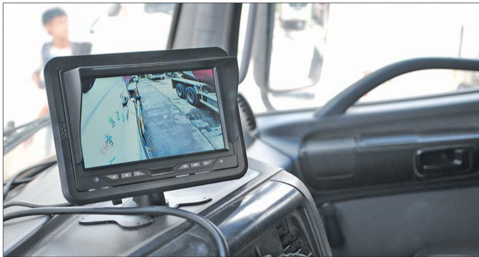
通过红外影像仪在车内可观察“视觉盲区”。
