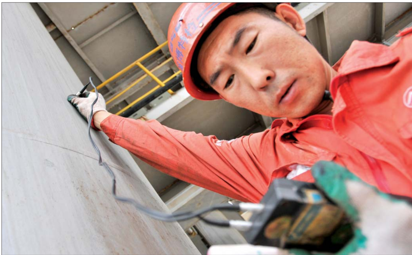
▲市质监局容器管道科的工作人员检查压力容器的厚度。 本报记者 王鸿哲 摄
