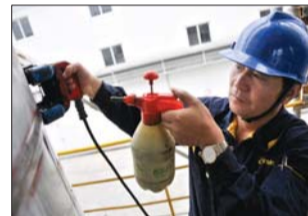
▲工作人员检测高温球罐的便面是否有裂缝。 本报记者 王鸿哲 摄
