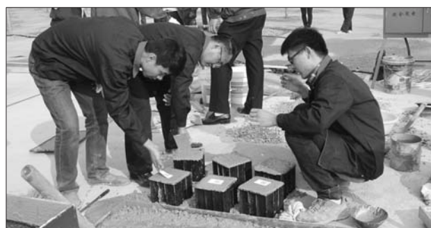
参赛选手在制作完成的混凝土试块上贴上二维码标签。
