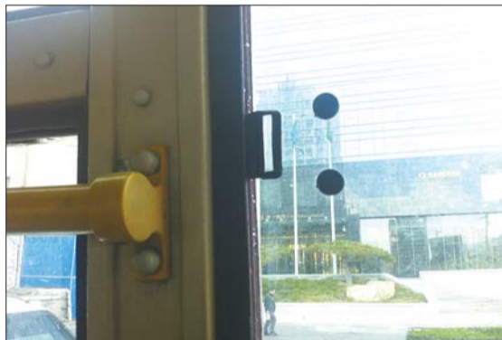
记者观察发现,“透风”的公交车多数是因为车窗锁损坏。本报记者 石磊 摄
