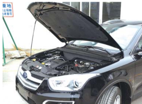
全新研发的ET3系列高性能全铝合金发动机。
