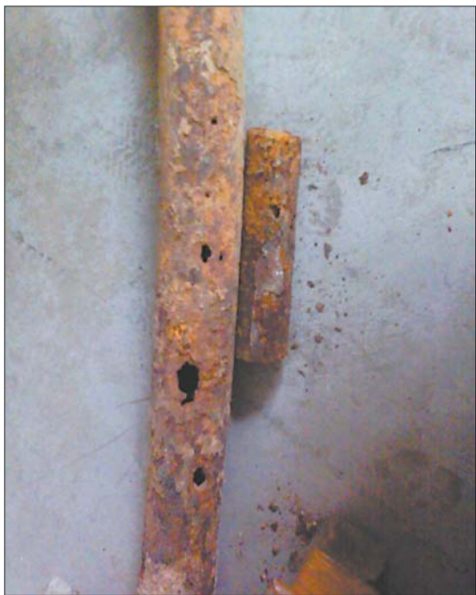
◀化纤小区内挖出的供水管网锈迹斑斑,腐蚀严重。
