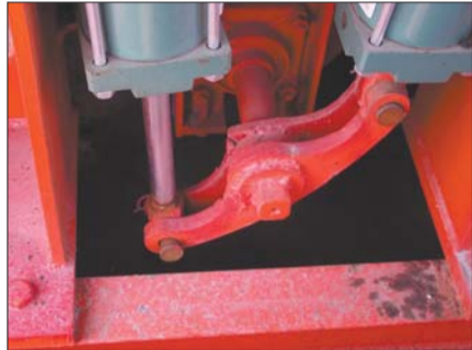
蔡先生收到的设备焊接粗糙。
