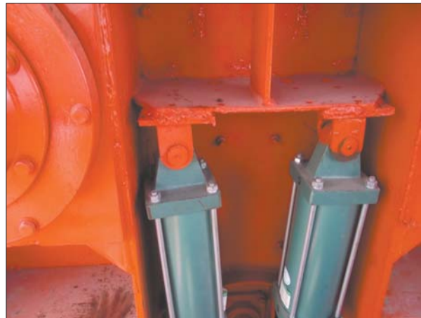
蔡先生收到的设备焊接粗糙。
