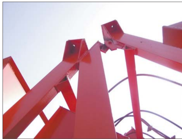
该设备断裂的主梁。
