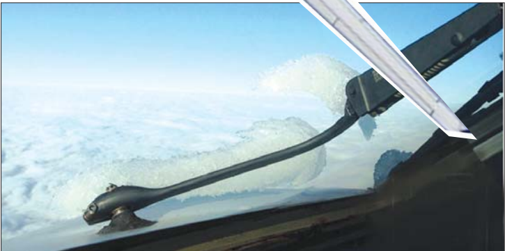
新支线飞机还意外遇到了一次间断最大结冰气象条件，这是一种非常罕见的气象条件，往往伴有严重紊流和冰雹，极易对飞机产生损伤。
