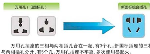
万用孔插座的三相与两相插孔合在一起,有3个孔。新国标插座的三相与两相插孔分开,有5个孔。万用孔插座不牢靠,多次使用易起火。
