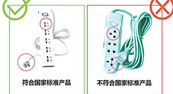
凡是插板上有三孔插孔但插座本身自带的插头上却只有两个插销的产品,都是问题插座。无地线即无保命线,电器漏电无保障。
