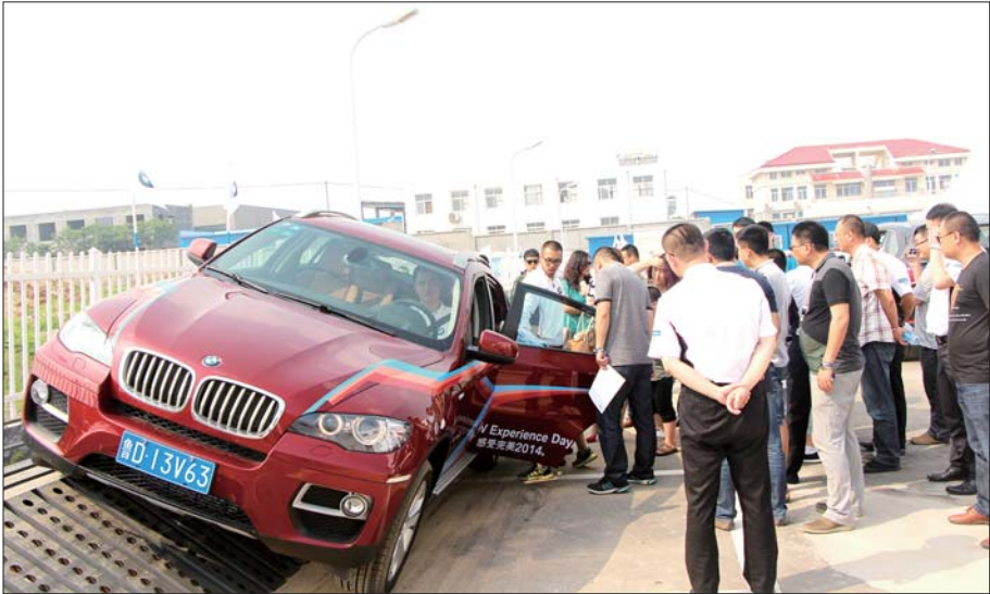
BMW 全轮驱动系统测试对坡道打滑轮胎进行锁止避免动力流失。
