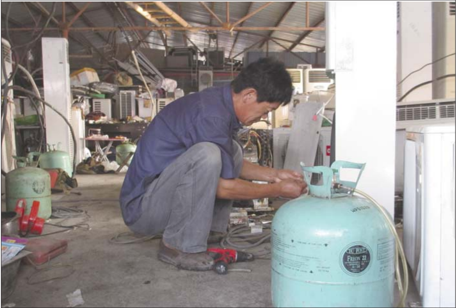
空调维修工正在维修空调、充氟。 本报记者 李超 摄
