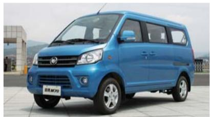
启腾M70在行车安全保障方面也有独到之处,这主要体现在外部照明系统和警示系统上。启腾M70采用了高亮、高穿透性前大灯、前雾灯系统,以及多功能安全组合尾灯。全车共8处转向灯,配合启腾M70的超大角度后视镜,高亮度高穿透性雾灯,使启腾M70车身全周无盲区,车主不但可以更好地观察到周边和车后的情况,而且转向信号也更明朗,夜间行车更加醒目,雨雾天气更容易被辨识,从而全面保障行车安全。更重要的一点,启腾M70配备了只有轿车才会配备的EPS电动助力转向系统,该系统能够为车辆提供转向助力,使驾驶员在遇到突发情况的时候能够轻易地闪避。同时,转向力会根据车速变化自动进行调整,当车速大于80KM/H时,该系统将不再提供助力,确保高速行驶不会“漂”,更平稳,全面提升了行车的安全性。结合前碟后鼓式9寸高性能制动器,启腾M70在行车安全方面创造了极为优秀的表现,全面超越了目前市场上的其他微客车型。(庆伊)
