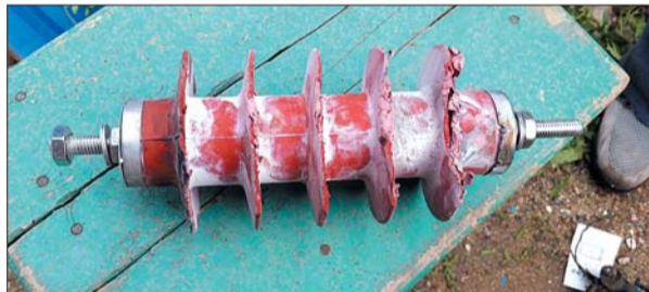
爆炸损坏的氧化锌避雷器。
