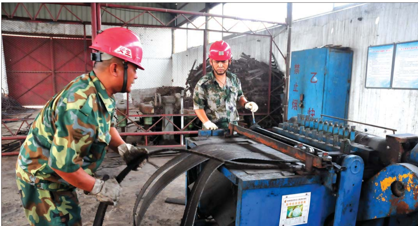
职工利用自制设备对废旧皮带进行切割利用。
