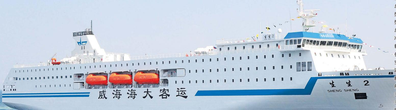
"生生 2" 轮是目前国内唯一一艘满足 SOLAS 公约关于客轮安全返港要求的滚装客轮。CCS 船级,总吨位 20826 吨,总长 165 米,宽24米,结构吃水5.95米,主机功率4500KW×2台,船速18.5节,定员2240人,车道线长度1100米,车辆限高4.86米, 车辆甲板负荷 120 吨。该轮总投资 3.2 亿元,2012 年 4 月 26 日开工建造,2013 年 6 月 23 日建造完工,2013 年 7 月 11 日首航。
