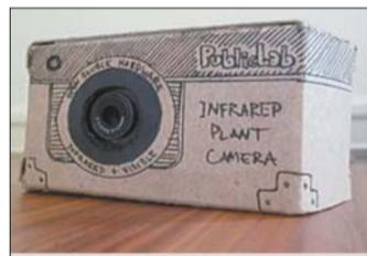
这款照相机的开发原本是基于监控在墨西哥湾湿地上英国石油公司漏油事件对植物生命所造成的影响。三年后,该组织研发了一套过滤系统,这套系统可用来探测任何指定区域的红外线和普通有规律性光源的数量,从而找出二者存在不同地方的区域。除了反射红外线,健康的植物会在可见光谱中吸收光源。所以当照片是用过滤光点拍摄出的就证明这是一个健康的植物。这个Infragram由三个部分组成。首先是一组过滤器,成本是10美元,这个过滤器可使任何普通照相机摇身一变成为红外线照相机。第二个是需要一个35美元的网络摄像头,这可使我们抓取快像以便在电脑上进行分析。最后这个团队想要研发一个简易的200像素的数码相机,这个相机内置的红外线过滤器可提供高质量的照片。
