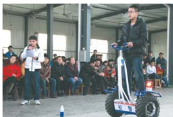
学生自行设计的双电机同轴自平衡电动车。
