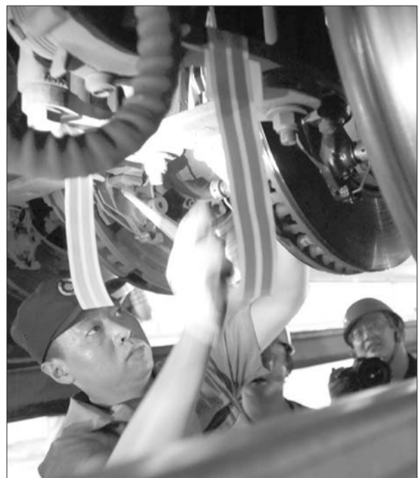
检修人员更换刹车片。
