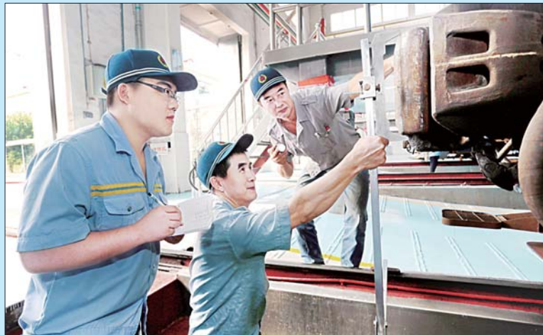
在秋季整修工作中,济南西机务段对机车设备进行全面检查整治,消除冬季惯性故障。图为检修人员检测车钩高度。 张汝峰 姜爱勇 摄影报道
