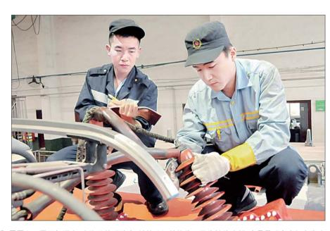
▲进入冬季,雾霾和雨雪天气增多,在潮湿的环境中,沾染尘污的绝缘子绝缘性能降低,容易导致电力机车发生"雾闪"、接地等故障,给运输安全带来影响。
