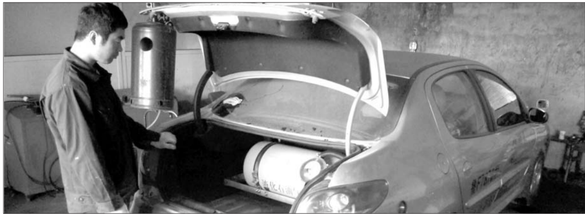
10日,在烟台一油改气工厂内,工人在改装车辆。 本报记者 钟建军 摄
