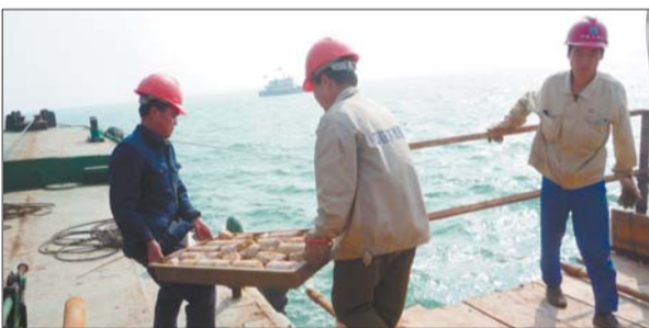
去年8月中旬,青岛地铁1号线进行海上勘测,勘测人员搬运钻取上来的岩芯。(资料片)
