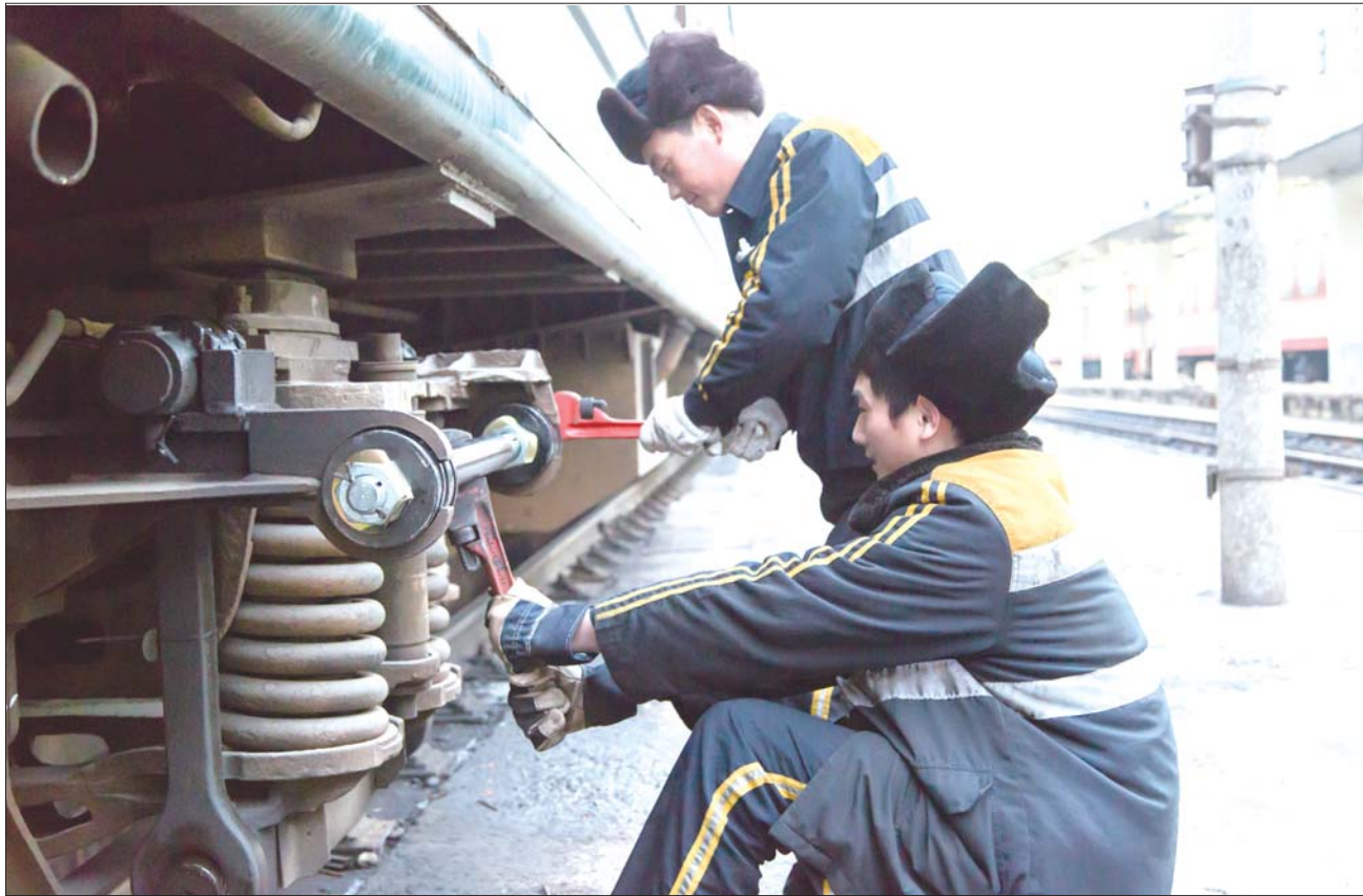
济南车辆段职工正在对屯兵车走行部进行整修。
