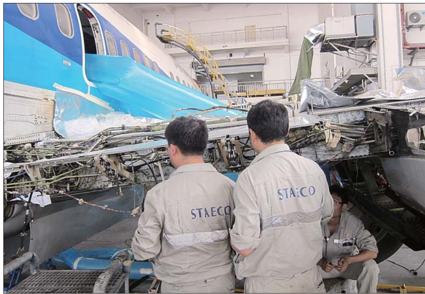
飞机大翼后梁修理完成后恢复原状。
