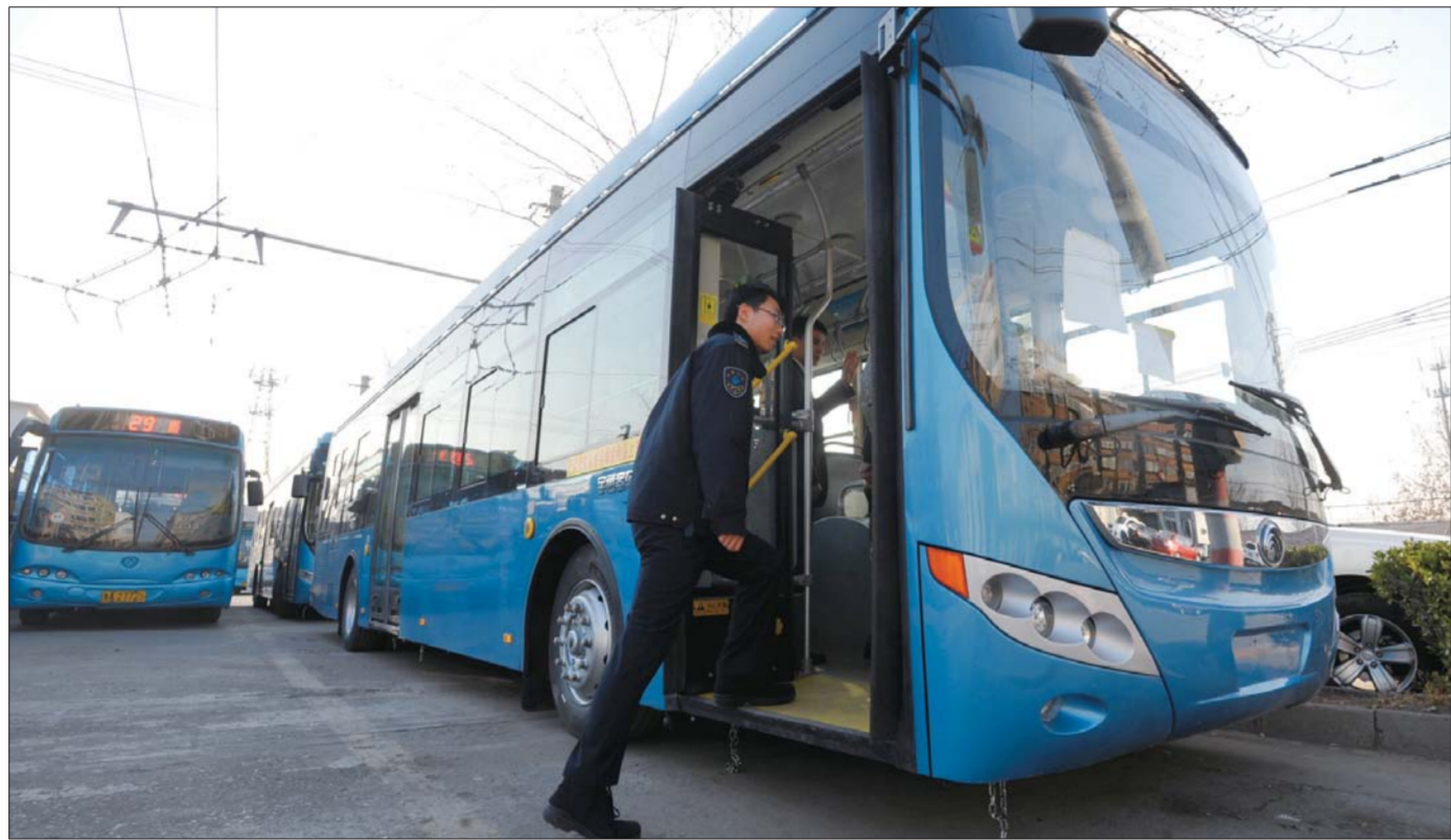
2013年12月,济南引进新一代双源无轨电车,电机首次采用交流电机,可以脱线运营10公里,新的电车改为一级踏步,方便了乘客上下车(资料片)。 本报记者 张中 摄
