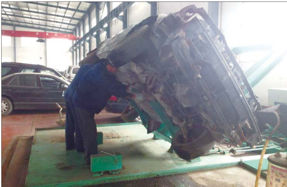
工作人员对车辆的底部组件进行拆除。本报记者 孟杰 摄
