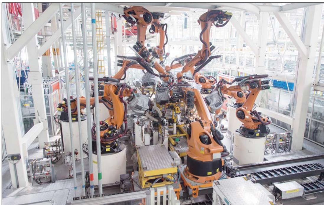
在一汽大众佛山工厂焊装车间,八台形似变形金刚的德国库卡焊接机器人,承接了高尔夫和奥迪A3底板骨架95%的焊接任务。 本报记者 姜宁 摄
