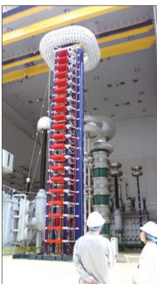
高新区企业中特高压电击实验中模拟雷电电击仪器。本报记者 修从涛 摄
