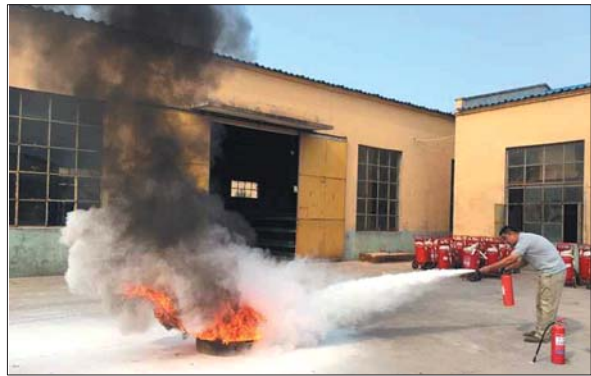
用滑石粉冒充干粉的灭火器的灭火效果。
