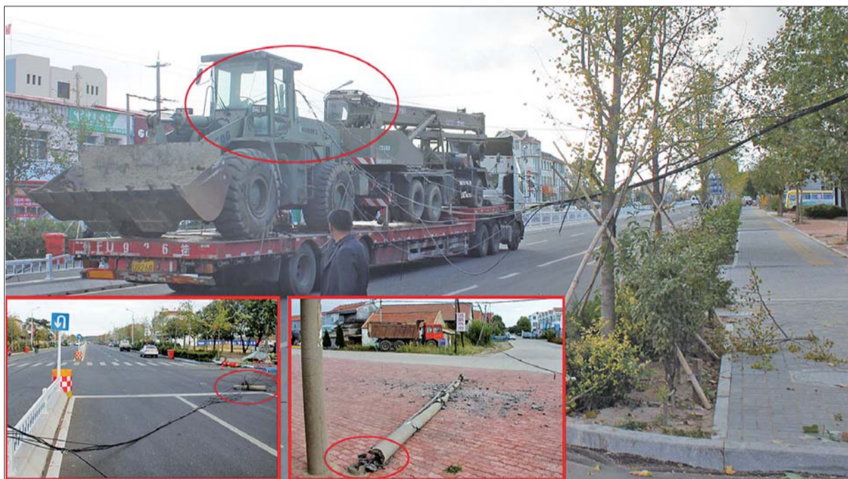
超高货车将多根线缆杆折断。
