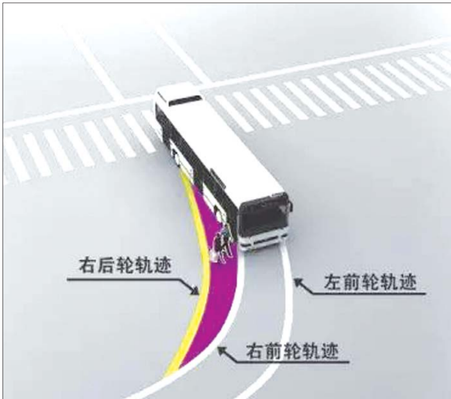
公交车右转弯视觉盲区
