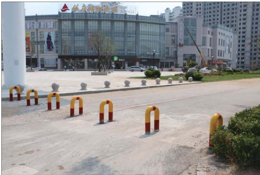
为便于非机动车通过,大学城内4处路段的U形路桩全部采用纵向安装。 本报记者 张帅 摄
