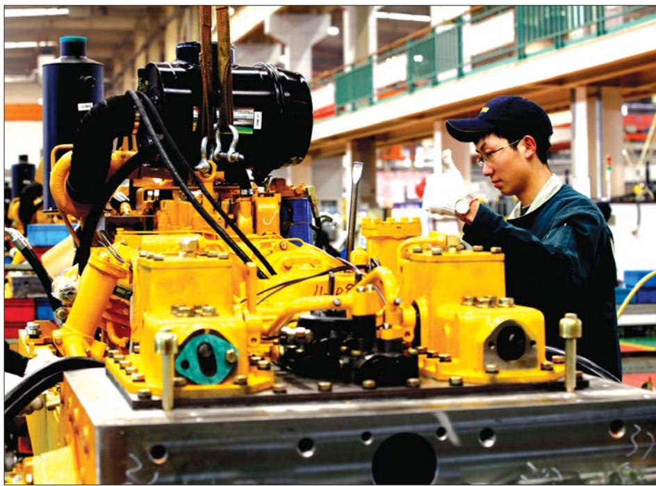
山推工人正在组装推土机。
