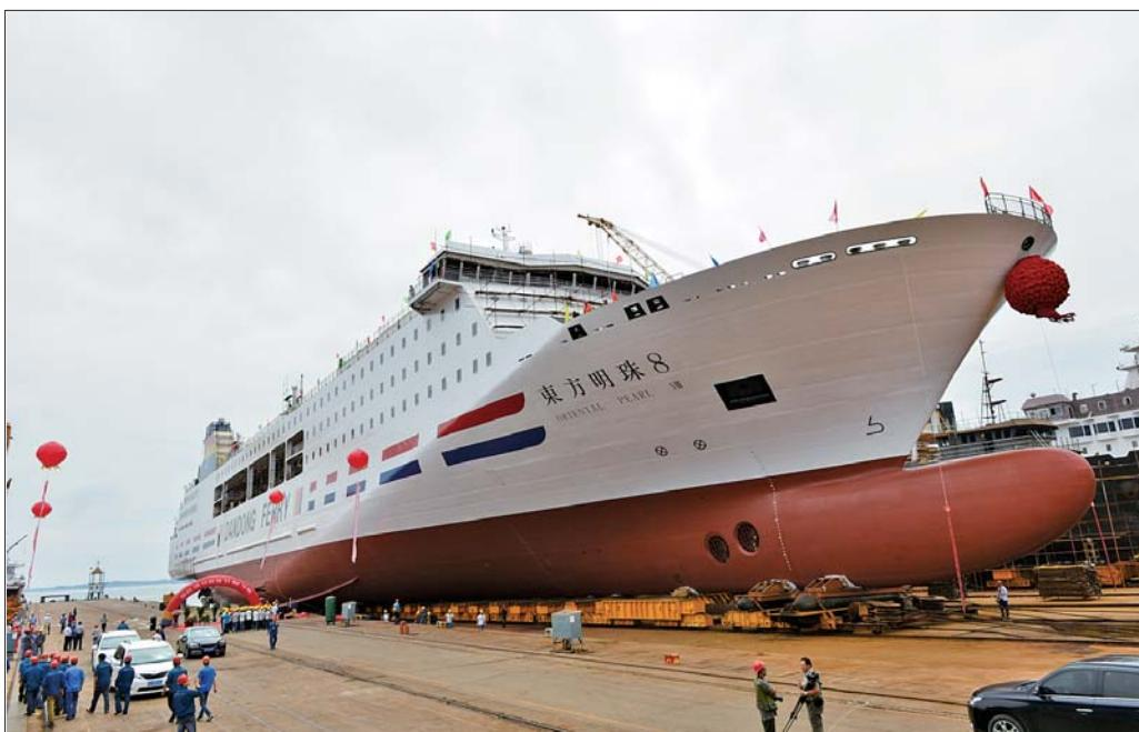
7月6日,由荣成市石岛管理区黄海造船有限公司为丹东国际航运有限公司建造的中韩航线豪华客滚船“东方明珠8”轮顺利下水。“东方明珠8”轮总长185米,型宽25.8米,总吨位为2.4万总吨,乘客定额为1500人,车道长度1400米,主要用于短途国际航行,承运旅客、轿车、载重汽车和集装箱拖车,设有超市、免税店、酒吧、影院、棋牌室、KTV房、等娱乐休闲场所。目前,黄海造船已先后承建5艘中韩航线客滚船。
