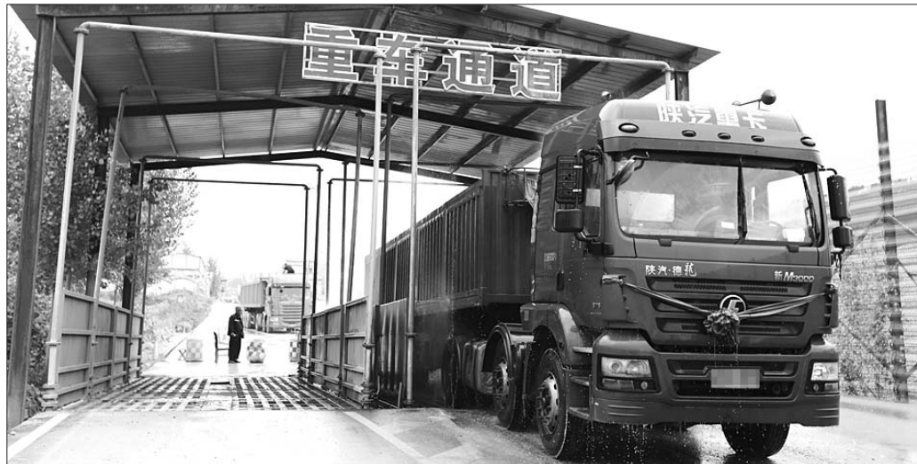
货车经过喷淋间。本报记者 张晓科 摄
