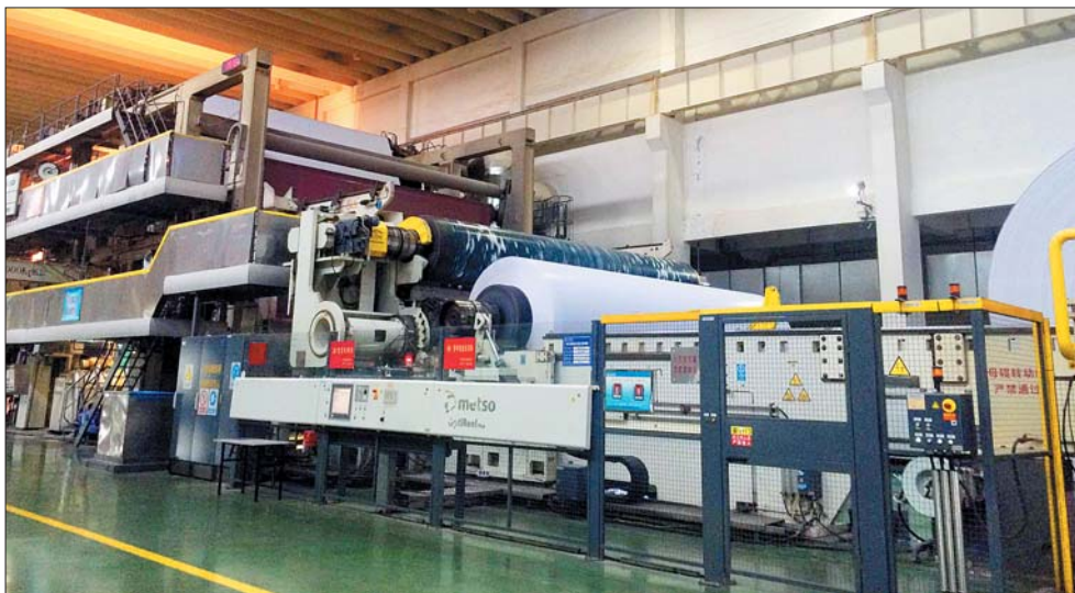
图为华泰集团年产70万吨铜版纸生产线,只需要200多名工人。而与德国福伊特公司合作进行改造前,年产20万吨的纸机需要3000多名工人。摄影 张亚楠
