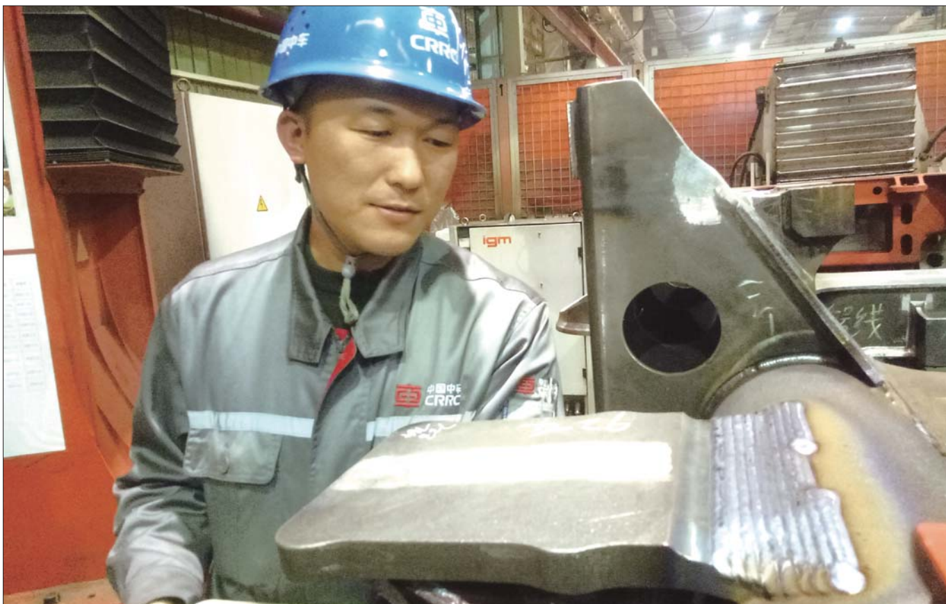
刘建树用多层多道错层一次性堆焊技术焊好一道焊缝。 本报记者 尹明亮 摄
