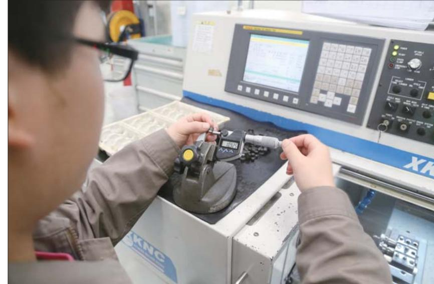
工作人员对生产出的螺母进行测量，每个螺母都要精确到千分之一毫米。本报记者 吕奇 摄
