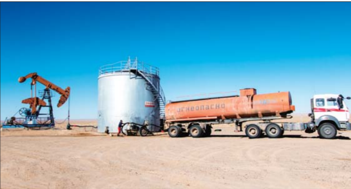
原油采用单井拉油的方式运至集油站。
