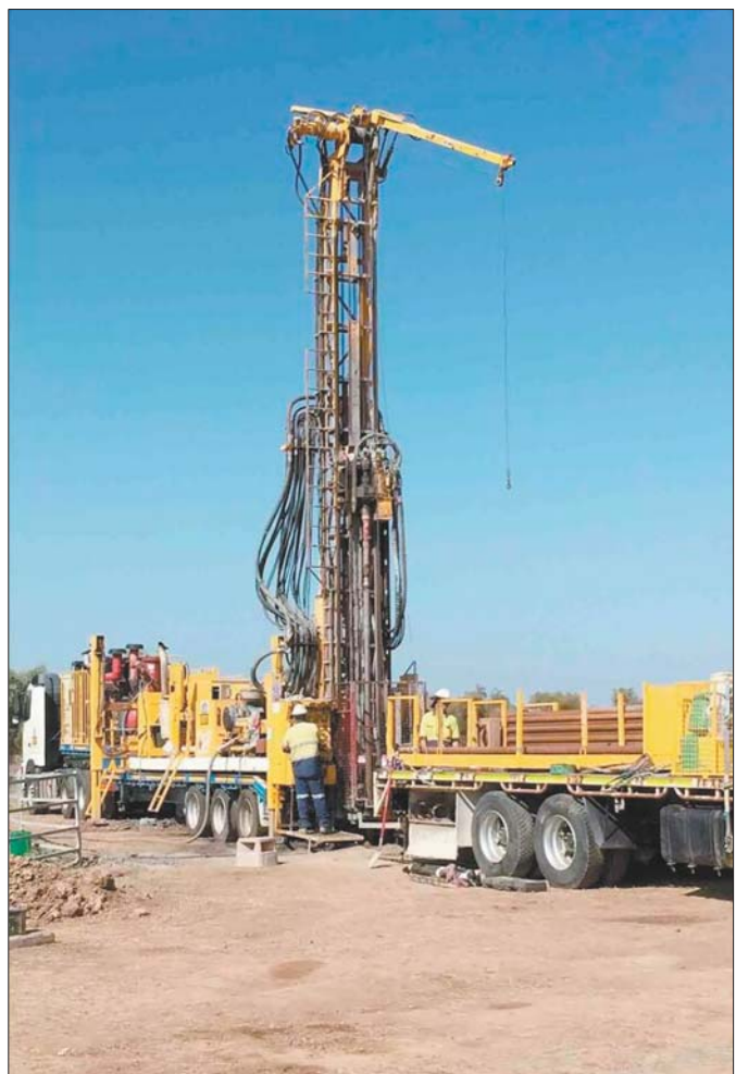
山能临矿集团在澳大利亚昆士兰州博文盆地有四个煤炭项目，目前，高耸的地质钻机正在日夜忙碌着。(资料片)
